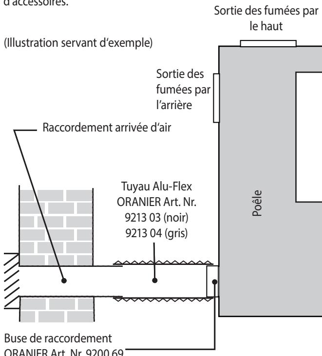
► En cas de connexion à l'air extérieur, veillez bien à ce que les conduits soient parfaitement étanches avec une entrée d'air face aux vents dominants.
